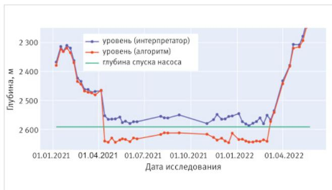
Рис. 7. Сравнение динамик изменения динамического уровня жидкости, рассчитанных интерпретатором вручную и автоматически с применением методов машинного обучения
