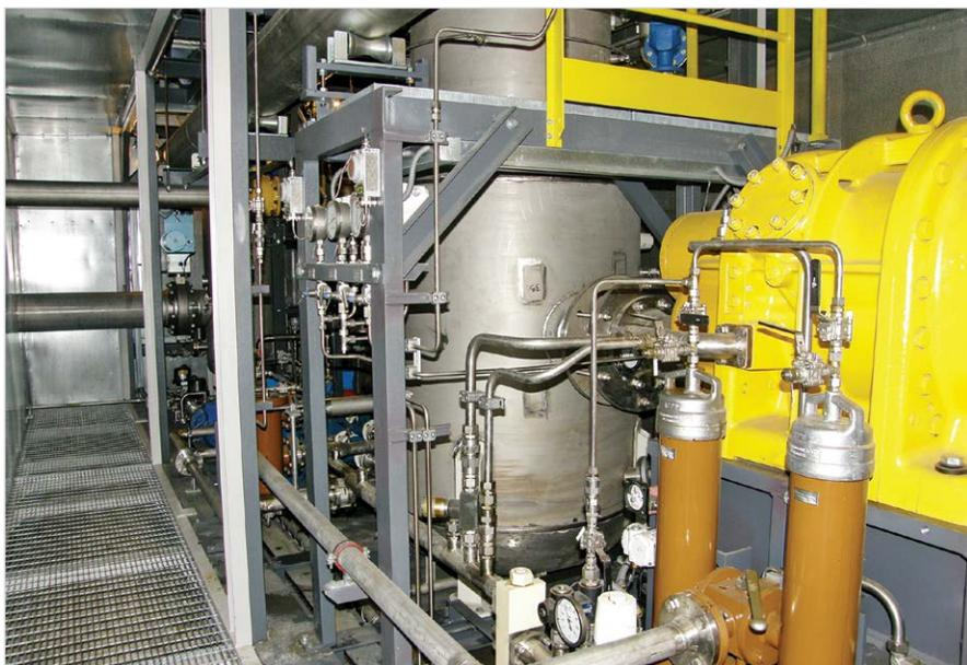
Фото 5. Компрессорная установка в арктическом исполнении
