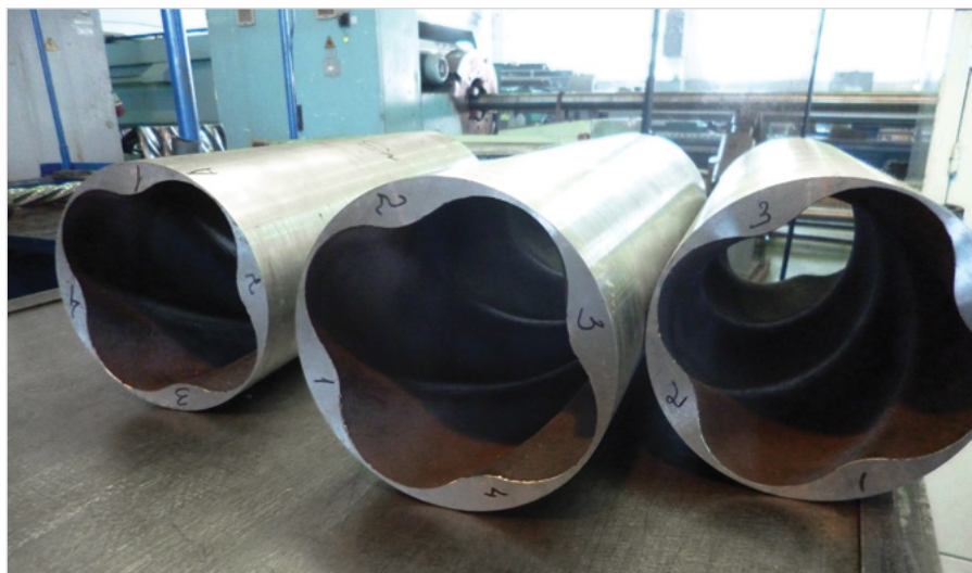
Рис. 6 — Литые вкладыши для армирования статора
