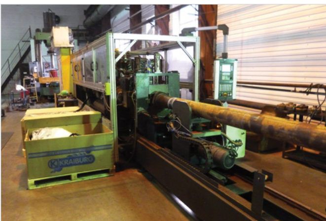
Рис. 4 — Заливка статора резиновой смесью на литейной машине «Desma»
