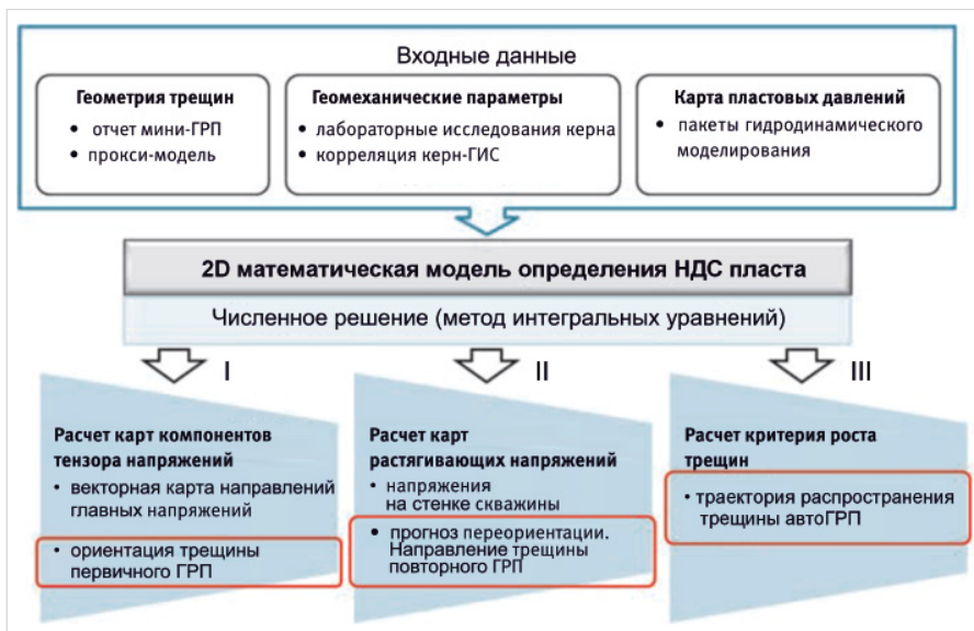
Рис. 1. Входные данные и результаты расчетов программного модуля [7] Fig. 1. Input data and calculation results of the software module [7]
