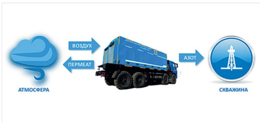
Рис. 2. Схема процесса получения газообразного азота из воздуха
