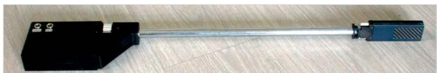
Рис. 3 — Цифровой рентгеновский преобразователь
