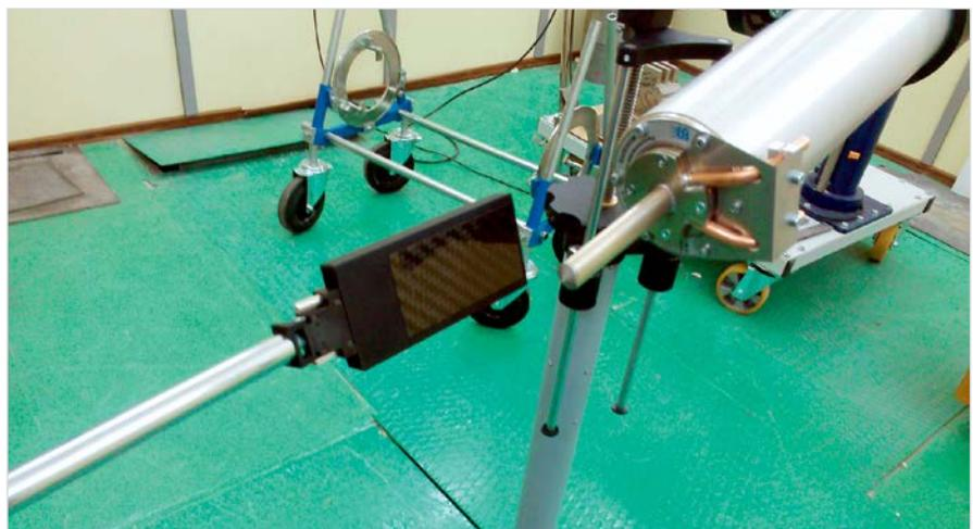
Рис. 1 — Штативное устройство с установленными преобразователем и излучателем
