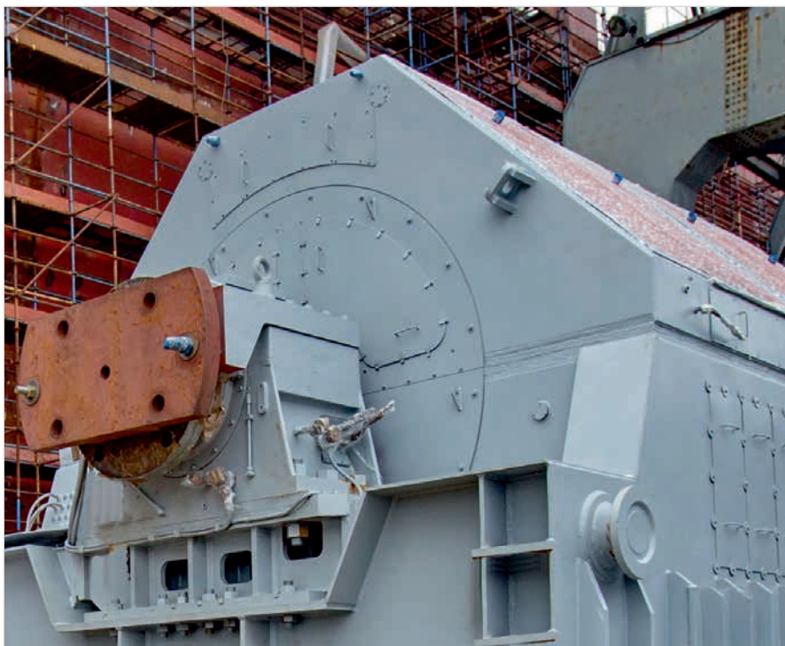
Фото 1. Гребной электродвигатель для новейших атомных ледоколов – гигант весом 300 тонн
