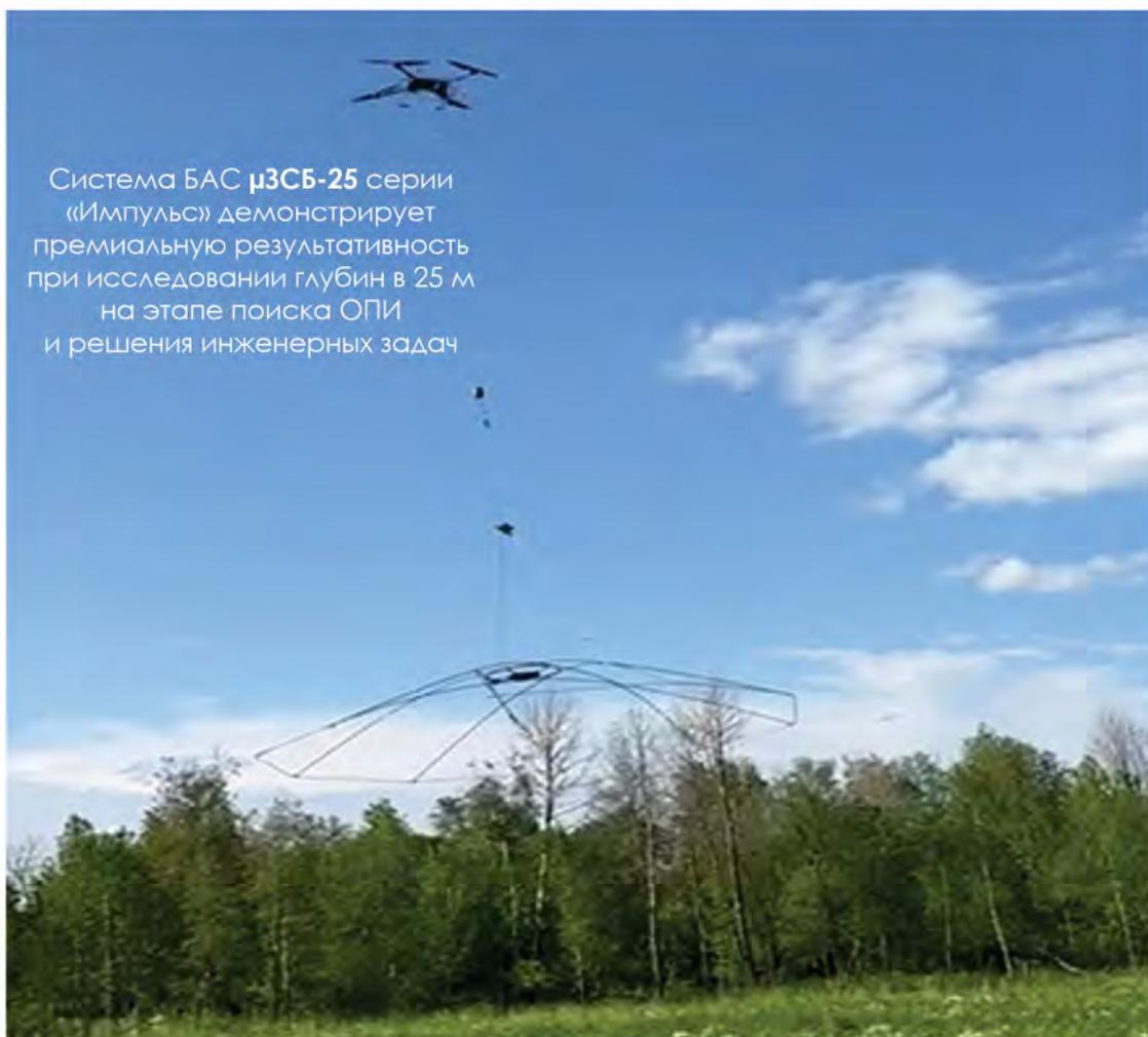
Система БАС μЗСБ-25 серии «Импульс» демонстрирует премиальную результативность при исследовании глубин в 25 м на этапе поиска ОПИ и решения инженерных задач
