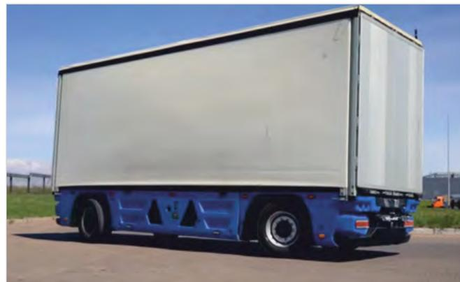
Рис. 3. Беспилотный грузовик на электрической тяге KAMAZ-3373 «Челнок» [10]
