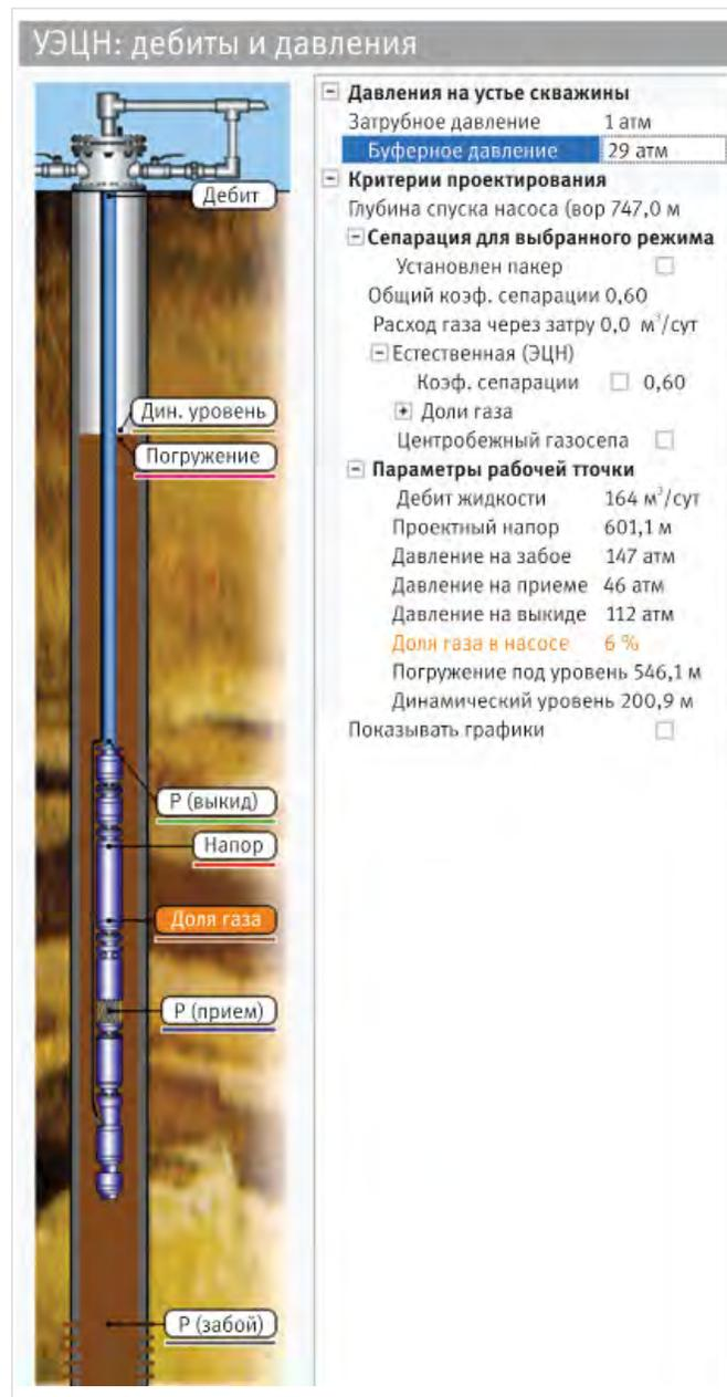
Рис. 4. Количество газа на приеме насоса при буферном давлении 2,9 МПа = 6 %
