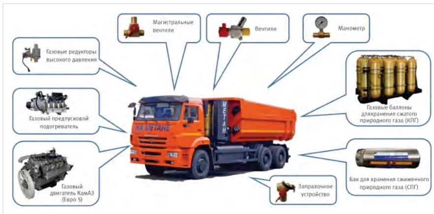
Рис. 1. Пример грузового автомобиля, работающего на газомоторном топливе [3, 4]
