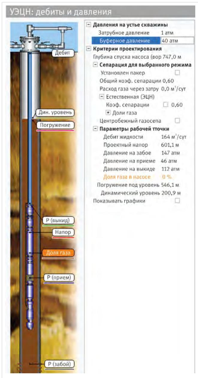
Рис. 3. Количество газа на приеме насоса при буферном давлении 4 МПа = 0 %
