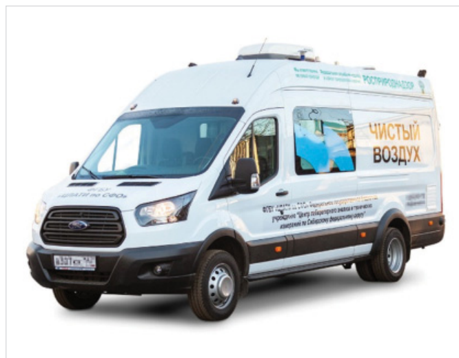
Рис. 3. Мобильная лаборатория контроля загрязнения атмосферы производства АО «НеваЛаб»
