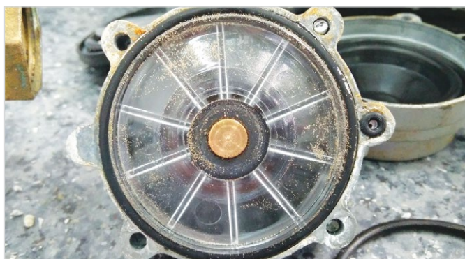
Рис. 12 — Песок и грязь на затворе ПЗК регулятора
