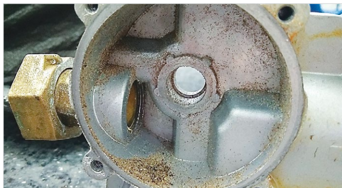
Рис. 13 — Песок внутри регулятора
