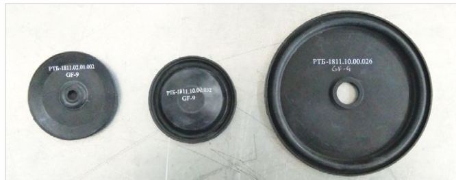
Рис. 11 — Мембраны бытового регулятора производства СП «ТермоБрест» ООО при эксплуатации при температуре -50°C
