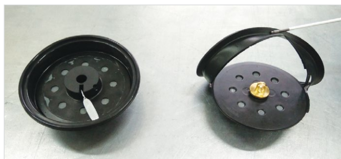
Рис. 9 — Состояние мембран бытового регулятора второго итальянского производителя после однократного пуска при температуре -50^{\circ}\text{C} : а — основная мембрана; б — мембрана ПЗК
