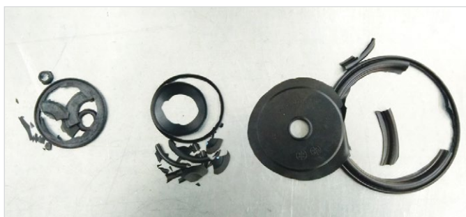
Рис. 8 — Состояние мембран бытового регулятора первого итальянского производителя после однократного пуска при температуре -50^{\circ}\text{C} : а — мембрана ПЗК; б — мембрана редуктора; с — основная мембрана
