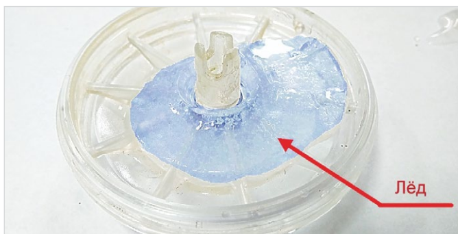
Рис. 6 — Большой кусок льда в ПЗК регулятора
