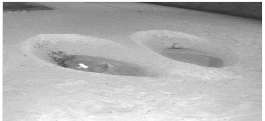
Рис. 5 — Фотография участка дна после воздействия на него струй от работающих гребных винтов модели судна
