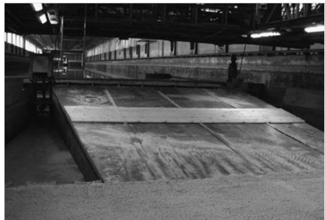
Рис. 3 — Внешний вид установки для создания течения
