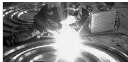
Рис. 4 — Плазменная закалка «погонов»
