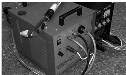
Рис. 1 — Установка для поверхностной закалки УДГЗ-200
