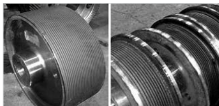
Рис. 3 — Крановые колеса и тормозной шкив с плазменной закалкой
