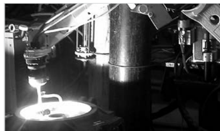
Рис. 2 — Закалка бурта наддрессорной балки вагонной тележки установкой УДГЗ-200 с помощью робота
