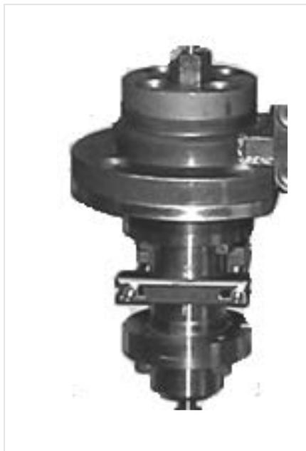
Рис. 1 — Внешний вид плунжерного насоса
