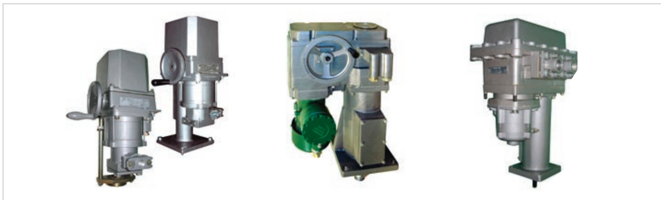
Рис. 3 — Взрывозащищенные электрические исполнительные прямоходные механизмы — МЭП Применяются с арматурой поступательного принципа действия (клапаны). Рабочее положение в пространстве — любое, определяемое положением арматуры. Механизмы с усилиями на выходном штоке 2500 и 6300 Н снабжены односторонним ограничителем наибольшего усилия на закрытие регулирующего органа. Механизмы с усилиями 25000 Н и выше снабжены двухсторонним ограничителем наибольшего усилия.
