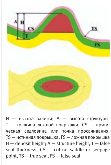
Рис. 1. Случаи наличия залежи УВ согласно представлениям о трехслойном строении природных резервуаров [1] Fig. 1. Cases of the presence of hydrocarbon deposits according to the concept of a three-layer structure of natural reservoirs [1]
