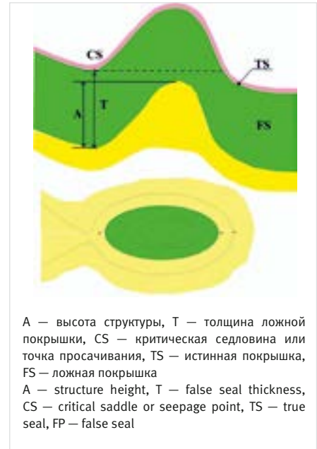
Рис. 2. Случаи отсутствия залежи УВ согласно представлениям о трехслойном строении природных резервуаров [1] Fig. 2. Cases of the absence of hydrocarbon deposits according to the concept of the three-layer structure of natural reservoirs [1]
