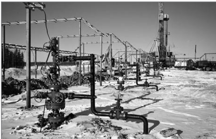
Рис. 7. Фонтанная арматура на нефтяном месторождении
