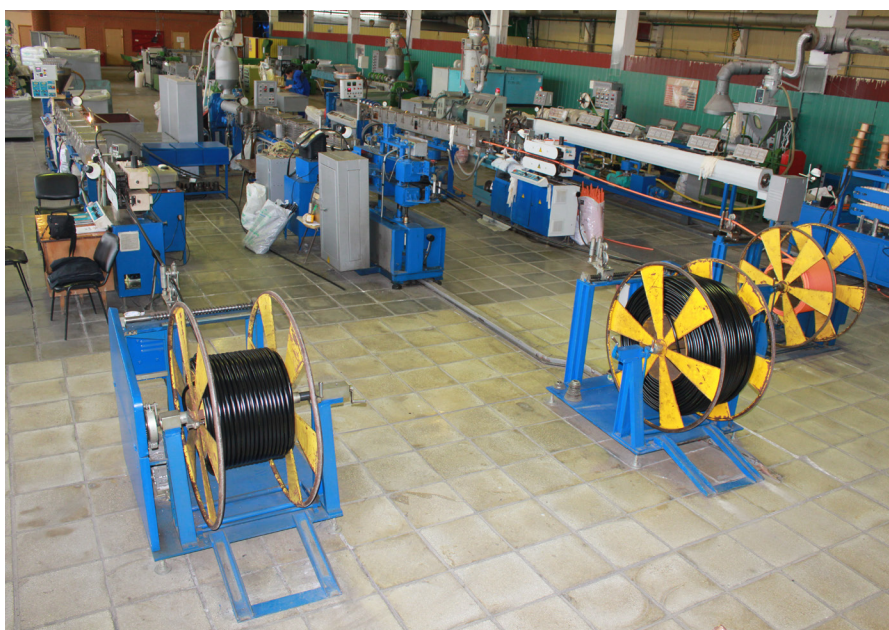
Производство заготовки термоусаживаемой трубки на червячном прессе
