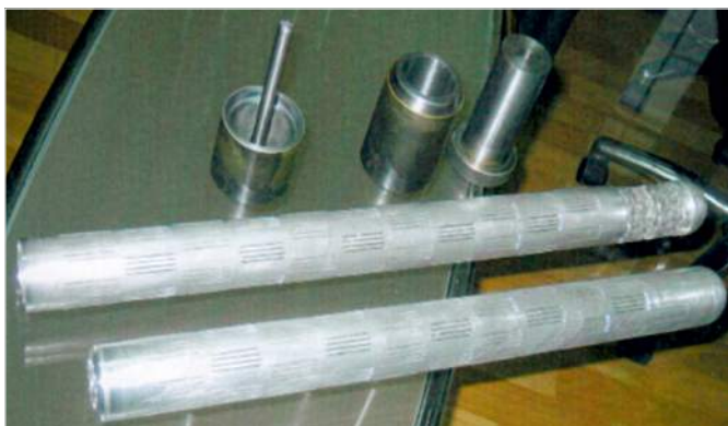
Рис. 2 — ТХЭ «ХИМОТЕРМ» для обработки скважин, продуцирующих тяжелые асфальтеносмолистые парафинистые нефти
