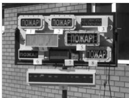
Рис. 1 — Стенд для испытаний табло
