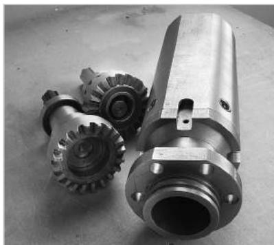
Рис. 7 — Редукторные вставки к винтовому насосу
