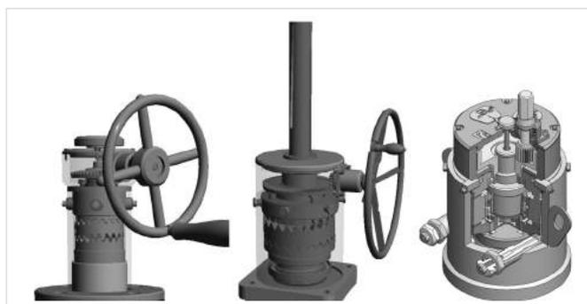
Рис. 2, 3, 4 — Конструкции ручного привода запорной арматуры на основе использования прецессирующей передачи
