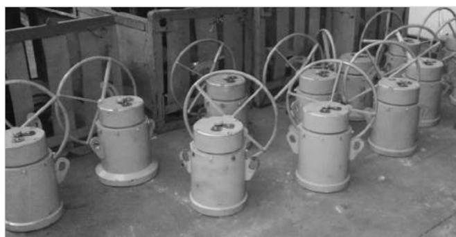
Рис. 5 — Приводы к шаровому крану ДУ-300
