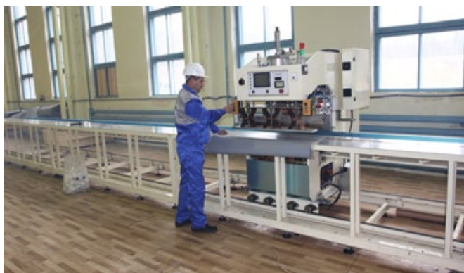
Рис. 6 — Сварка полимерного материала линией ТВЧ
