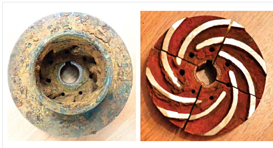
Рис. 2 — Коррозионное повреждение закрытого рабочего колеса: а) общий вид рабочего колеса; б) задний диск разрезанного рабочего колеса
