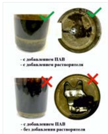
Рис. 3. Влияние добавления углеводородного реагента-растворителя на эффективность разделения эмульсии «кислотный состав – нефть» (пример) [13] Fig. 3. Effect of adding hydrocarbon reagent-solvent upon the separation efficiency of "acid composition – oil" emulsion (example) [13]
