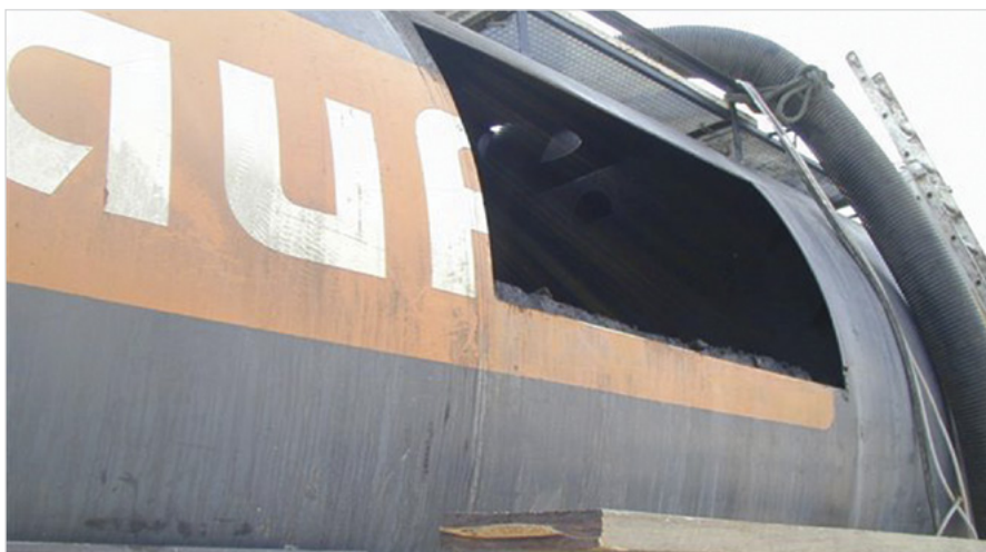
Рис. 3 — Гидроабразивная резка цистерны
