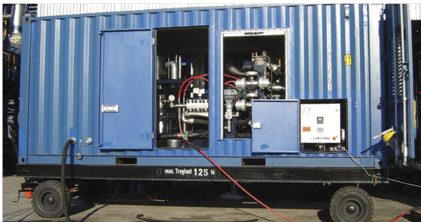
Рис. 1 — Агрегат WOMA VG400M с дизельным приводом (2500 бар, 56 л/мин., г. Нижнекамск)
