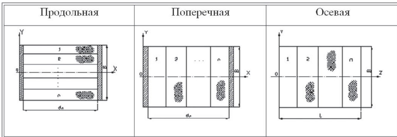
Таб. 2. Вид неоднородности контролируемой среды датчика с плоскими электродами
