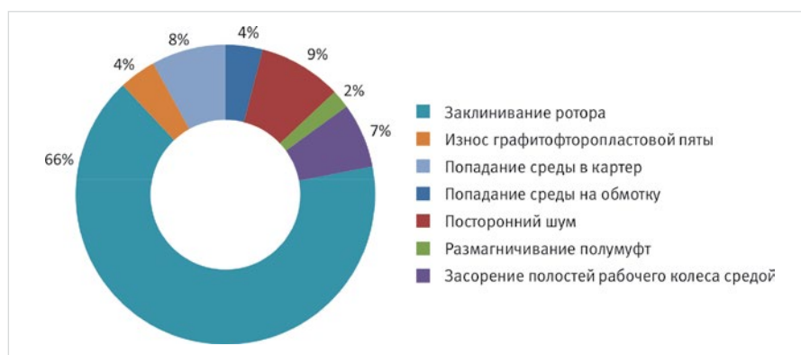
Рис. 1 — Распределение типов отказов горячих насосов
