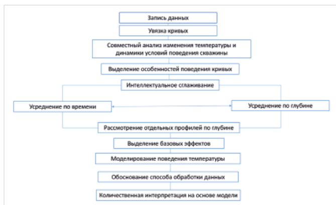
Рис. 1. Методика интерпретации оптоволоконных данных Fig. 1. Methodology for interpreting fiber optic data
