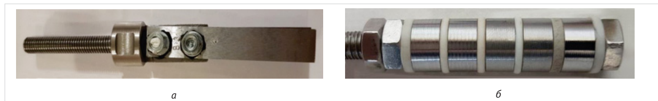
Рис. 3. Типы ОС, устанавливаемых в УКК: а — пластинчатый, б — цилиндрический
